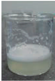
Imagen: Solubilidad de las fibras del plátano según el método de la NTC 481 Fuente Propia
