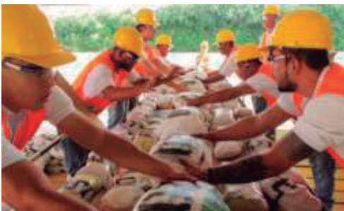
Fig. 3: Distribución durante prueba estructural del ala.
