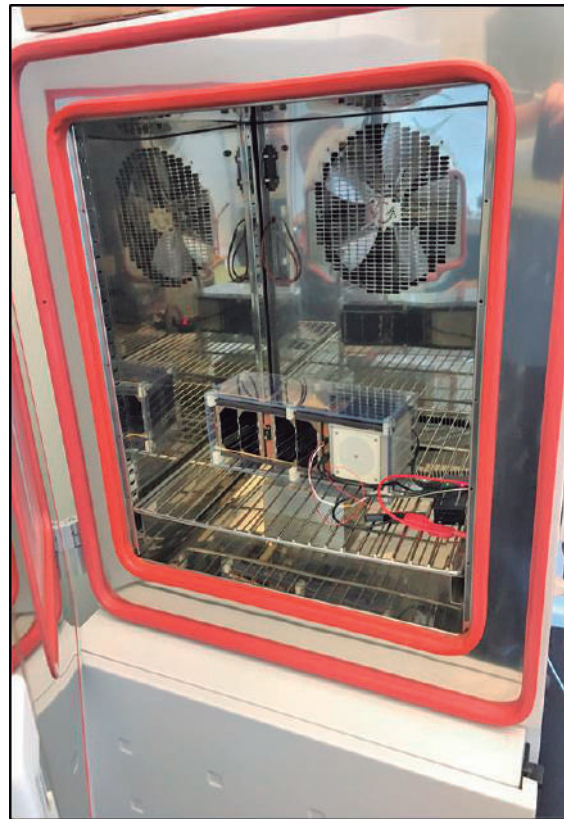
Figura 2. Prueba de ciclo térmico FACSAT-1
