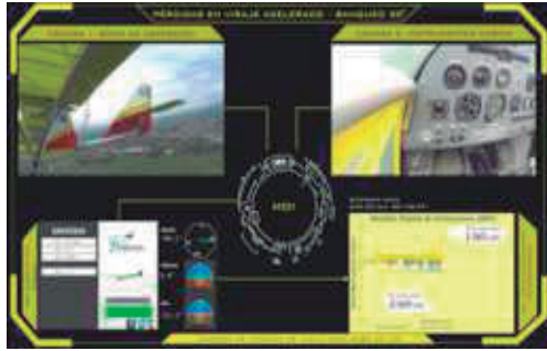
Fig. 5: Cámaras instaladas en la aeronave en ensayos de vuelo e interface de MDI sincronizados.
